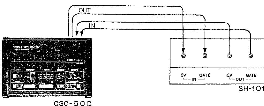
\* CV IN, GATE INの各ジャックにプラグを接続すると、CV及びGATEの内部接続は解除されます。
