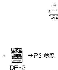
ホールド・ボタンを押すと（インジケーター一点灯），キーを離しても音を持続させることができます。この時のレベルはエンベロープジェネレーター（ENV）のサステインレベル（S）で決まります。従って、減衰音ではホールドすることができません。（P21参照）
